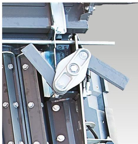
Les broyeurs de tiges en option montés à côté des rouleaux épanouisseurs, fournissent une coupe plus fine des résidus.
