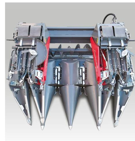
Système de repliage hydraulique offrant une faible hauteur du cueilleur pour le transport sur route.
